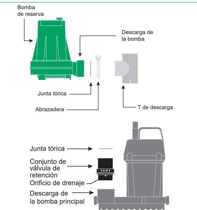
1. Deslice la abrazadera de acero inoxidable incluida sobre la descarga de la bomba de reserva. Presione la bomba de reserva en la T. Apriete la abrazadera. Enrosque la válvula de retención en la descarga de la bomba principal. Apriete a mano.
